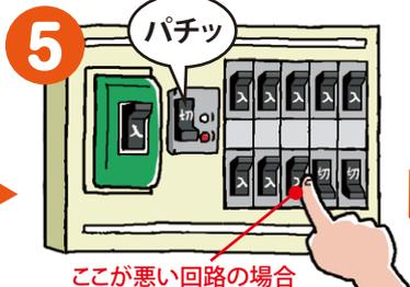
もし配線用遮断器を「入」にした時に再び漏電遮断器が切れたらその回路に漏電がある。
